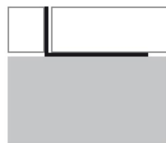
Afbeelding 3. Verwerking Tegelprofiel Recht in overgang van tegelvloer naar andere vloerbedekking (zij aanzicht).
