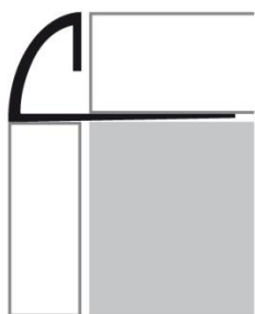
Afbeelding 1. Verwerking Tegelprofiel Rond in buitenhoek tegelwand (boven/zijaanzicht).
