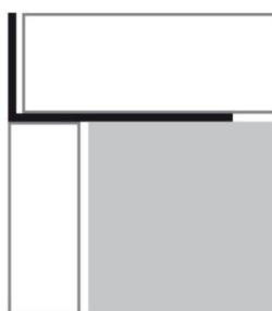
Afbeelding 2. Verwerking Tegelprofiel Recht in buitenhoek tegelwand (boven/zijaanzicht).
